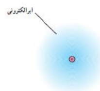
الف) در نبود میدان الکتریکی ، مرکز بارهای مثبت و منفی بر هم منطبق اند .
