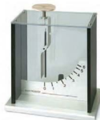
الف) تصویری از یک الکتروسکوپ درجه‌بندی شده بدون بار
