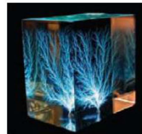
شکل ۱-۴۵ نقش های لیچنبرگ . فرو ریزش الکتریکی باعث تشکیل مسیرهای رسانایی سرخس شکلی در دی الکتریک شده است.
